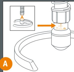
Das Federbein mit der aufgedruckten Gewichts-Skala in Richtung Fußring-öffnung in den Fußring stecken.
