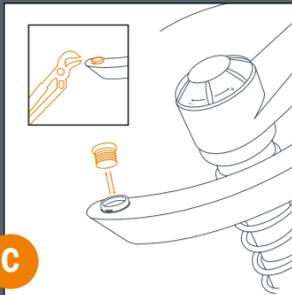
**Gleiter-Fußring:** **swopper** wird mit Metall- und Filzgleitern ausgeliefert. **Metallgleiter:** Nur für textile Böden nutzen. Nicht für Böden geeignet, die mit Feuchtigkeit in Berührung kommen. **Filzgleiter:** Für glatte Böden nutzen (Fliesen, Parkett, PVC u. ä.). **Gleiter-Wechsel:** Stellen Sie den **swopper** auf den Kopf und ziehen Sie die Gleiter mit einer Zange heraus. Setzen Sie die anderen Gleiter an deren Stelle und drücken Sie diese fest hinein.
