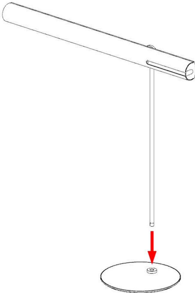
5. Achten Sie darauf, dass die Leuchte einen guten Stand hat und ziehen Sie die im Fuß befindliche Inbusschraube an, um die Stange zu fixieren.
